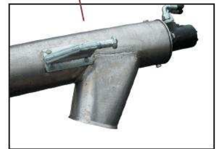
Tête de distribution avec moteur hydraulique
