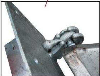
Plaques de maintien de l'ensemble sur la remorque
