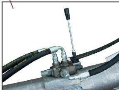
Commande d'avance, d'arrêt et de retour en arrière de la vis
